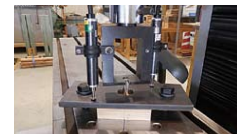
ネジ引き抜き試験風景
