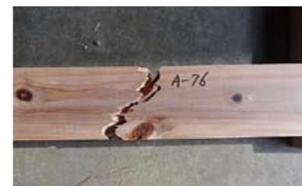
縦引張破壊例
