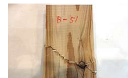
縦圧縮破壊例
